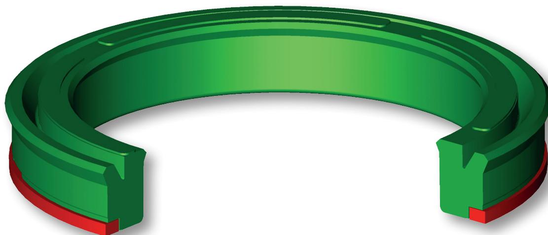
La tenuta pistone tipo KDA di Aston Seals è usata soprattutto in presenza di elevate pressioni e l'anello antiestrusione consente elevati giochi d'accoppiamento ed elevate deformazioni strutturali senza il pericolo di estrusione.
