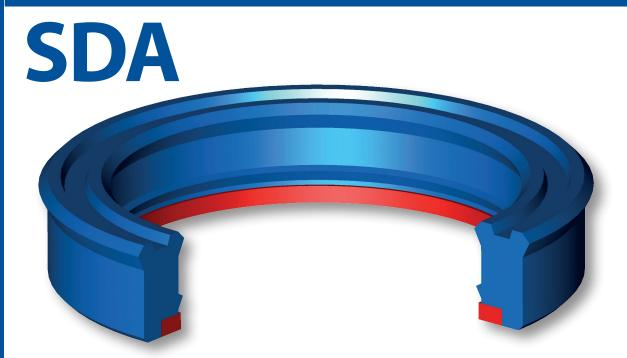
Questa guarnizione è utilizzata soprattutto in presenza di elevate pressioni e l'anello antiestrusione consente elevati giochi d'accoppiamento senza pericoli di estrusione.
